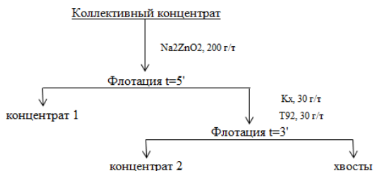
Рисунок 3 – Схема селекции с добавлением цинката натрия
