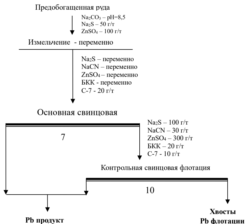
Рисунок 11 – Схема открытых опытов свинцового цикла
