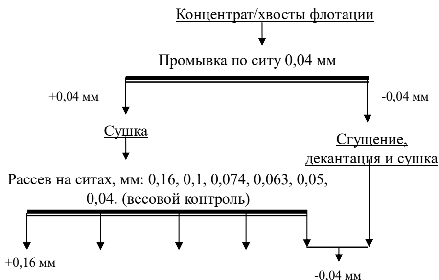
Рисунок 16 – Схема комбинированного ситового анализа продуктов флотации
